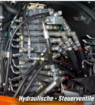
Hydraulische - Steuerventile
